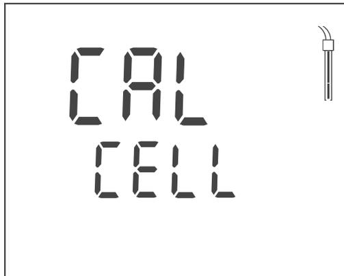
2 | Mit <ENTER> oder <CAL\_\_> die Auswahl CAL CELL bestätigen. Die Zellenkonstante der letzten Kalibrierung wird angezeigt.
